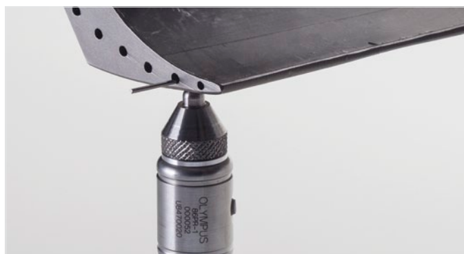
Измерение толщины стенок лопаток турбин с использованием стальной проволоки
