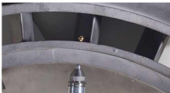
Измерение толщины деталей из литого металла 24,1 мм, использующихся в аэрокосмической промышленности
